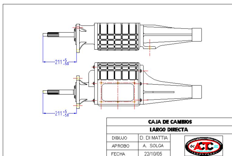
**FIG. 9- Esquema para caja Saenz TT3**
