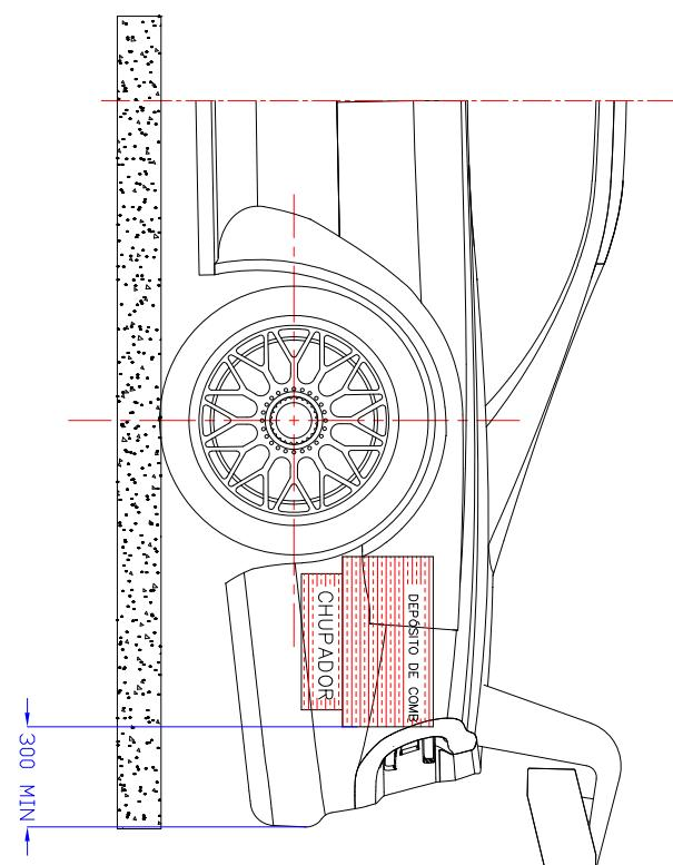
La fijación del depósito de combustible en relación a la altura del mismo es libre con la condición que él mismo como todos sus accesorios (chupador) estén en el interior del vano baúl.
