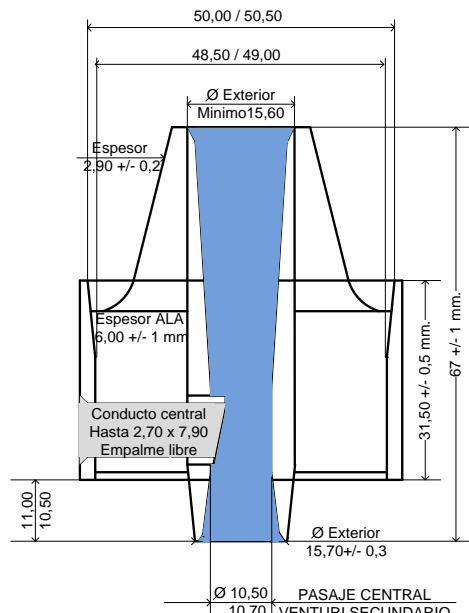
**INC.7:** *Está permitido retirar los tapones de bronce del cuerpo de los carburadores 48/48 IDA para proceder al mecanizado y agregado de material con el solo objetivo de nivelar la altura de las perforaciones que descargan combustible en el conducto de los centradores. -La altura mínima del centro del canal de emulsión al apoyo de la tapa debe ser de 15 mm.-Ver esquema. -*
